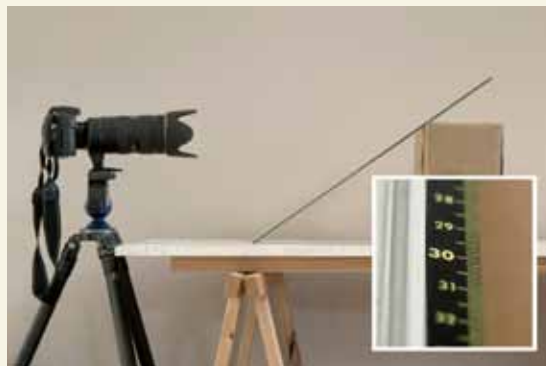
Opstelling voor scherpte-test met liniaal. Inzet: het resultaat geeft het werkelijke scherptediepte bereik weer van het objectief. (BS)
