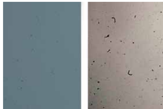
Zichtbaar vieze sensor bij test opname met f22. Links: zoals de foto uit de camera komt. Rechts: na extreem versterken van contrast (BS)
